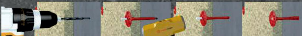
Просверлить отверстие через утеплитель
