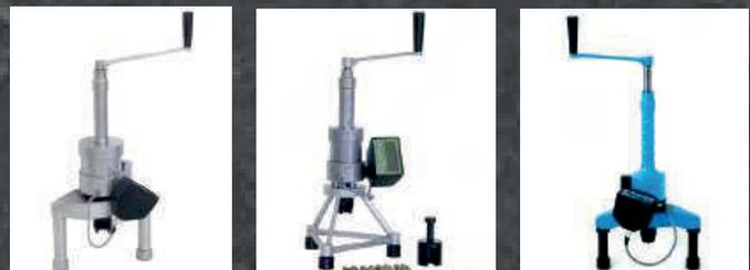
В лаборатории имеется поверенное испытательное оборудование компании Стройприбор (Россия) для испытаний на вырыв дюбелей для теплоизоляции, дюбель-гвоздей, фасадных анкеров, клиновых анкеров, химических анкеров совместно со шпилькой и арматурой.
