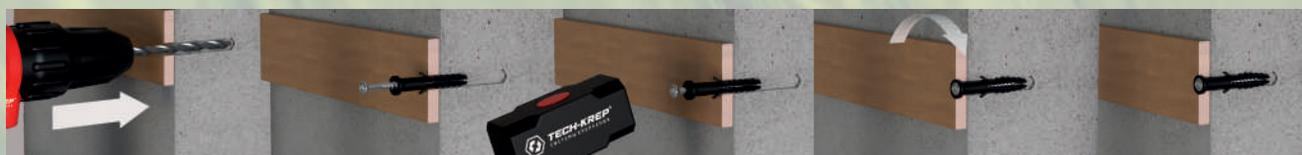
Просверлить отверстие через толщину закрепляемой детали
