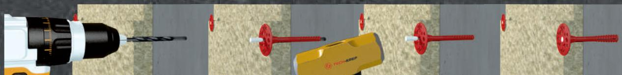
Просверлить отверстие через утеплитель
