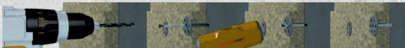
Просверлить отверстие через утеплитель
