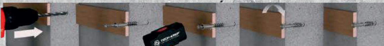
Просверлить отверстие через толщину закрепляемой детали
