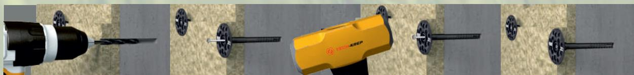
Просверлить отверстие через утеплитель
